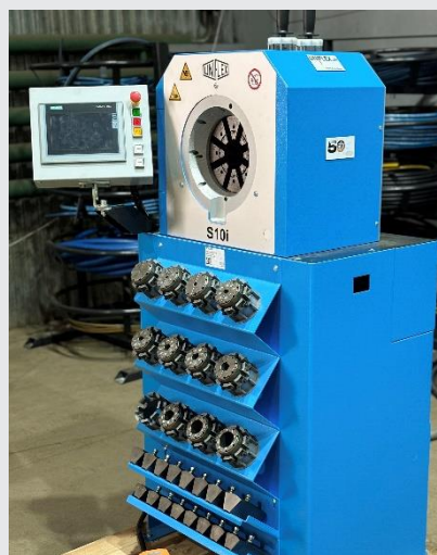
Современный обжимной станок - высокая точность процесса сборки РВД
